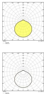
**Technische Daten Ledvance Led-Wand- Und Deckenleuchte Surface Rund 18W 1440lm - 830-850 CCT | 350mm - IP44 - Mit Bewegungs- Und Lichtsensor**
