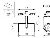
Technische Daten Philips LED Schienenstrahler Spot Greenspace Maxos Fusion GEN2 ST321S Weiß 23.5W 2700lm 38D - 830 Warmweiß
